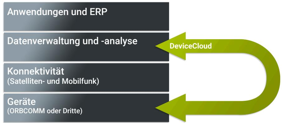
*DeviceCloud bedient Anwendungen durch Bereitstellung der Verbindung zwischen zwei Ebenen der IoT-Stapel - Geräte- und Datenverwaltung*
