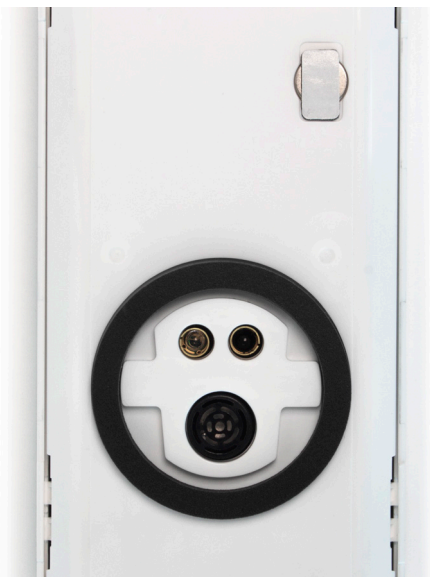
Die Unterseite des GT 1210 mit integriertem Ladesensor und Manipulationsanzeige.
