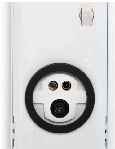
A parte inferior do GT 1210, com sensor de carga integrado e selo de detecção de violação.
